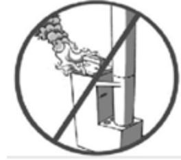
**OPOZORILO!** Hladna voda in topel zrak (temperaturna razlika / vlažnost zraka) pogosto povzročita kondenzirano vodo na dnu in zato peč ne pušča, čeprav je v peči nekaj vode. (Ni predmet garancijskega popravila)
